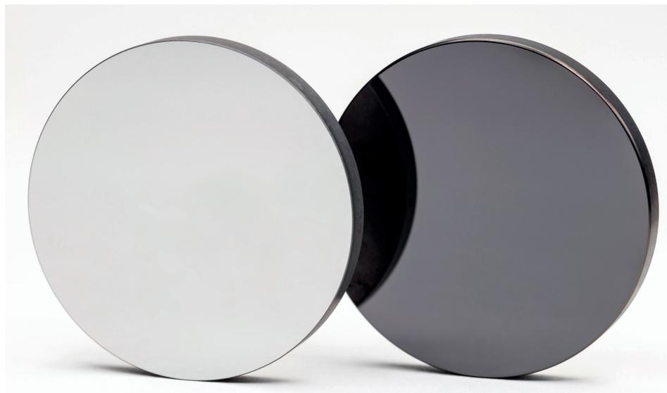
**Verschleißschützende Eigenschaften:** hohe Mikrohärtigkeit, niedrige Gleitreibung und eine Anti-Haft-Wirkung gegenüber Metalloberflächen sind typisch für diamantähnliche Kohlenstoffschichten © pro-beam
